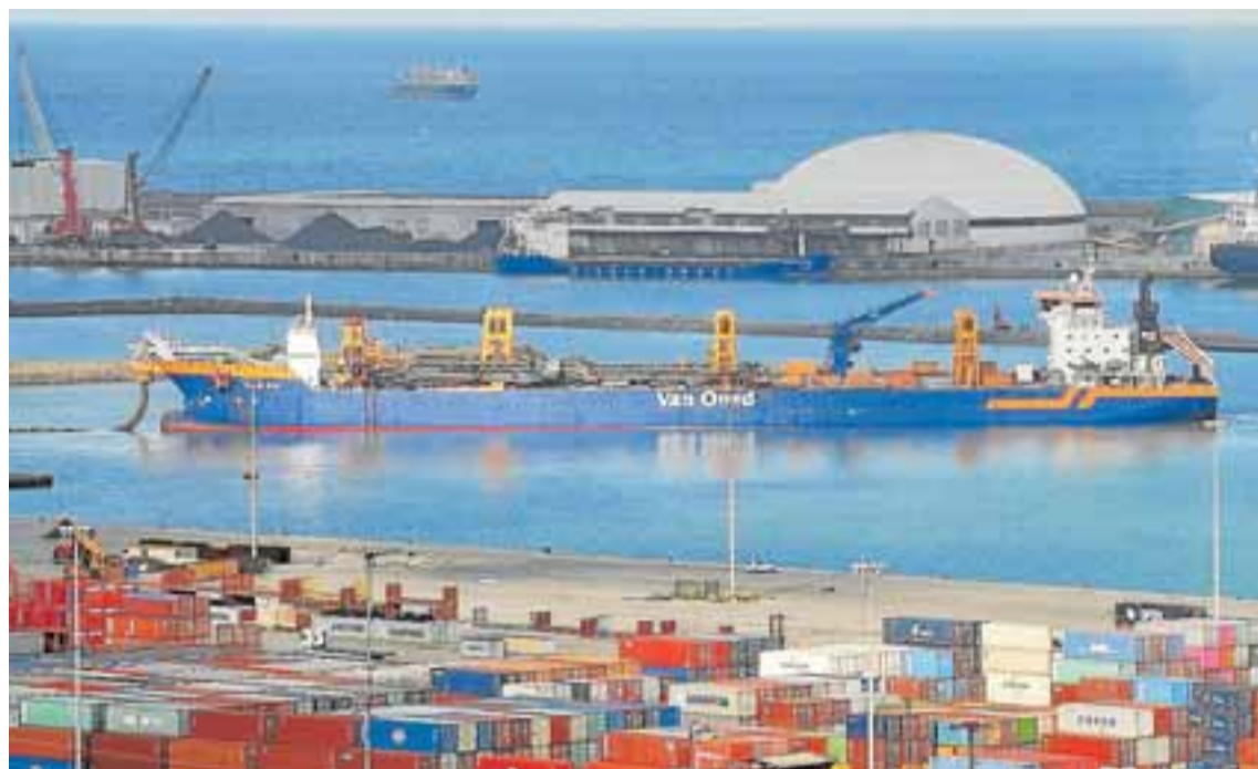
La gran draga 'Ham 318' deposita la arena extraída por una manga ubicada en la proa. Foto: A. P. B.
