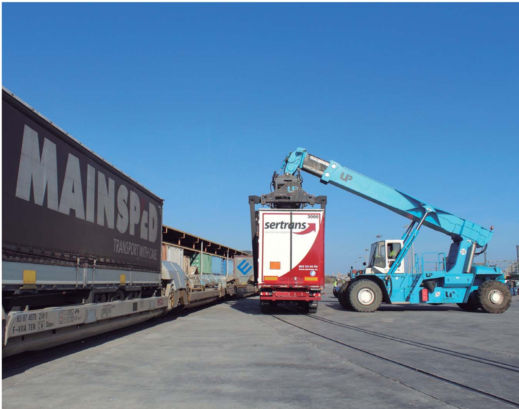
Carga de un semirremolque en la terminal de Can Tunis en el servicio de autopista ferroviaria que cubre la ruta Barcelona-Bettembourg.
